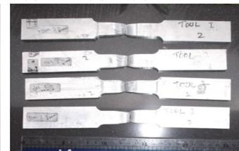
Hasil *friction stir welding* bentuk pin silinder ulir
