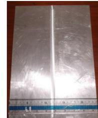
Hasil *friction stir welding* bentuk pin silinder ulir
