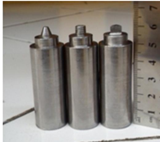
Gambar 10. Bentuk Pin FSW
